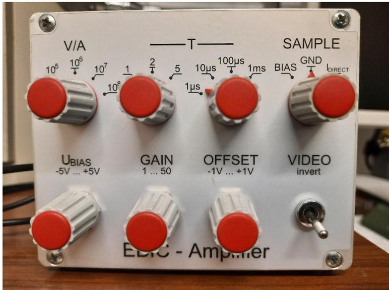
**Abb. 12:** EBIC Verstärker mit den Möglichkeiten zur Einstellung von Verstärkungsfaktor (V/A, gain), Zeitkonstante (T) und Offset (-1 V .. +1V). In der Einstellung BIAS kann mit
