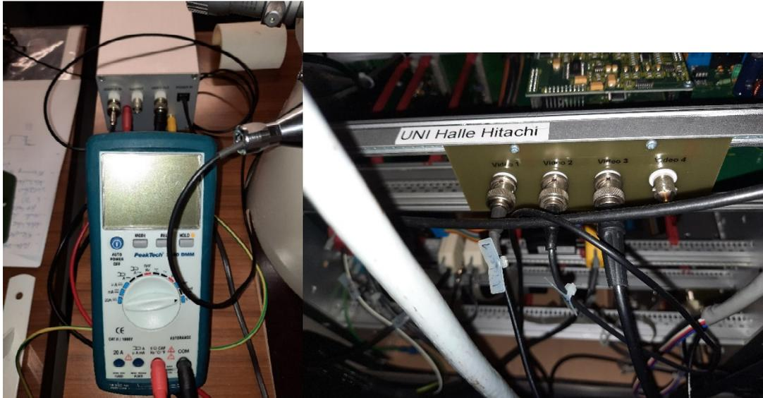
**Abb. 17:** Monitor (Voltmeter) zur Kontrolle der eingestellten BIAS-Spannung (links) sowie Schaltung des Ausgangssignal des EBIC-Verstärkers auf Video 3 des Messrechners (rechts).
