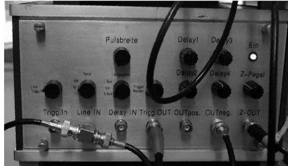
Abb. 5: Impulssteuergerät
