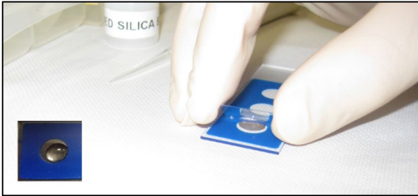
Abbildung 48 Tropfen der Glaskügelchen-Suspension auf dem Objektträger
