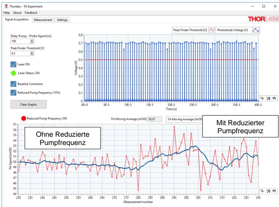
Abbildung 31 Erhöhtes Rauschen des TA-Signals durch Reduzierte Pumpfrequenz.
