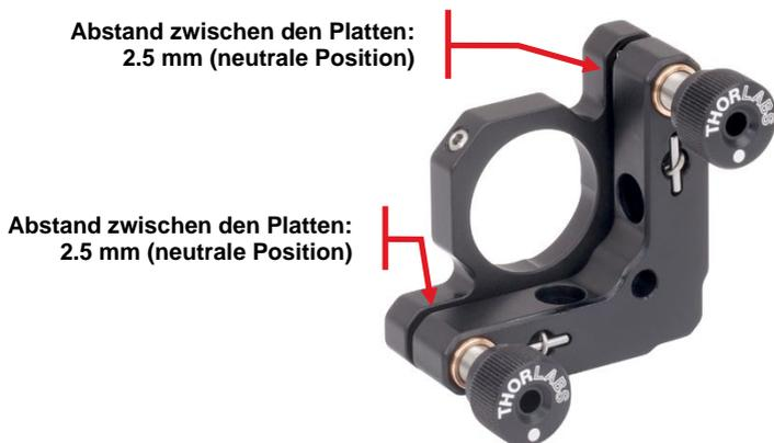
**Abbildung 58 Neutrale Position des KM100 Spiegelhalters**
