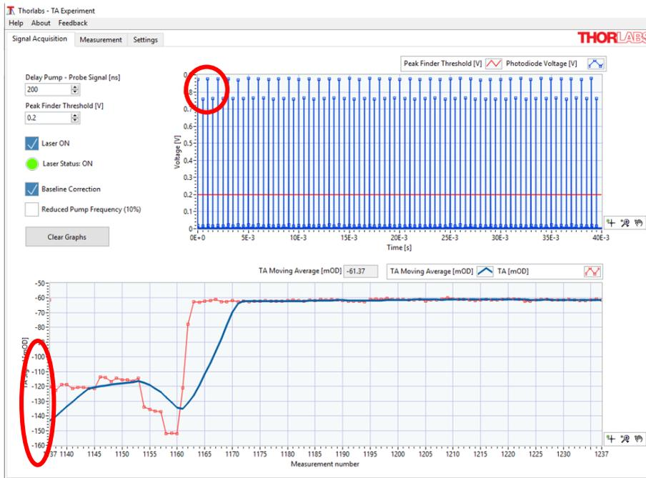
**Abbildung 90** Beispiel für das Signalverhalten für einen in den Detektor streuenden Pumplaser. Hier verursacht durch Entfernen der Irisblende und des Filters vor dem Detektor.
