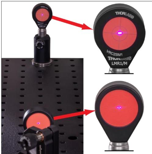
Abbildung 61 Justierhilfe mit Fadenkreuz (oben) und Justierhilfe mit Loch (unten) nach erfolgreichem Beamwalk.
