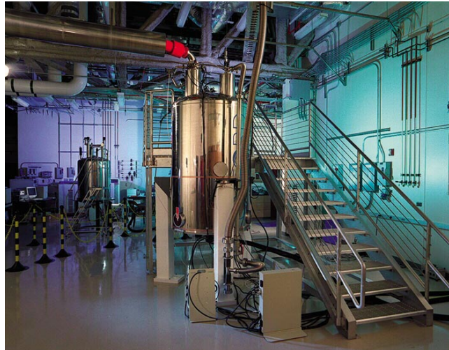
Magnet eines NMR-Spektrometers
