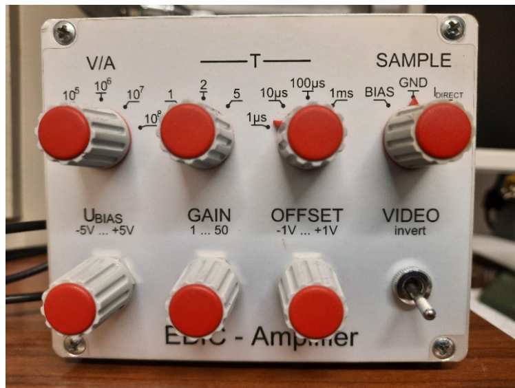
Abb. 13: EBIC Verstärker mit den Möglichkeiten zur Einstellung von Verstärkungsfaktor (V/A, gain), Zeitkonstante (T) und Offset (-1 V ... +1V). In der Einstellung BIAS kann mit U_{BIAS} die Probe zwischen -5V und +5V vorgespannt werden. Mit Invert wird die Farbskala des EBIC-Bildes invertiert.
