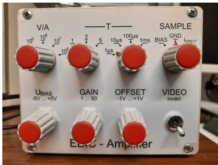
Abb. 13: EBIC Verstärker mit den Möglichkeiten zur Einstellung von Verstärkungsfaktor (V/A, gain), Zeitkonstante (T) und Offset (-1 V ... +1V). In der Einstellung BIAS kann mit U_{\text{BIAS}} die Probe zwischen -5V und +5V vorgespannt werden. Mit Invert wird die Farbskala des EBIC-Bildes invertiert.
