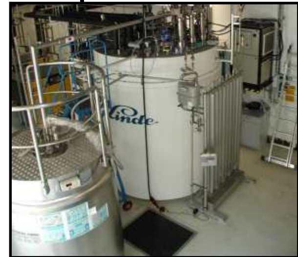
Helium Liquifier LINDE 200 W @ 1,8 K
